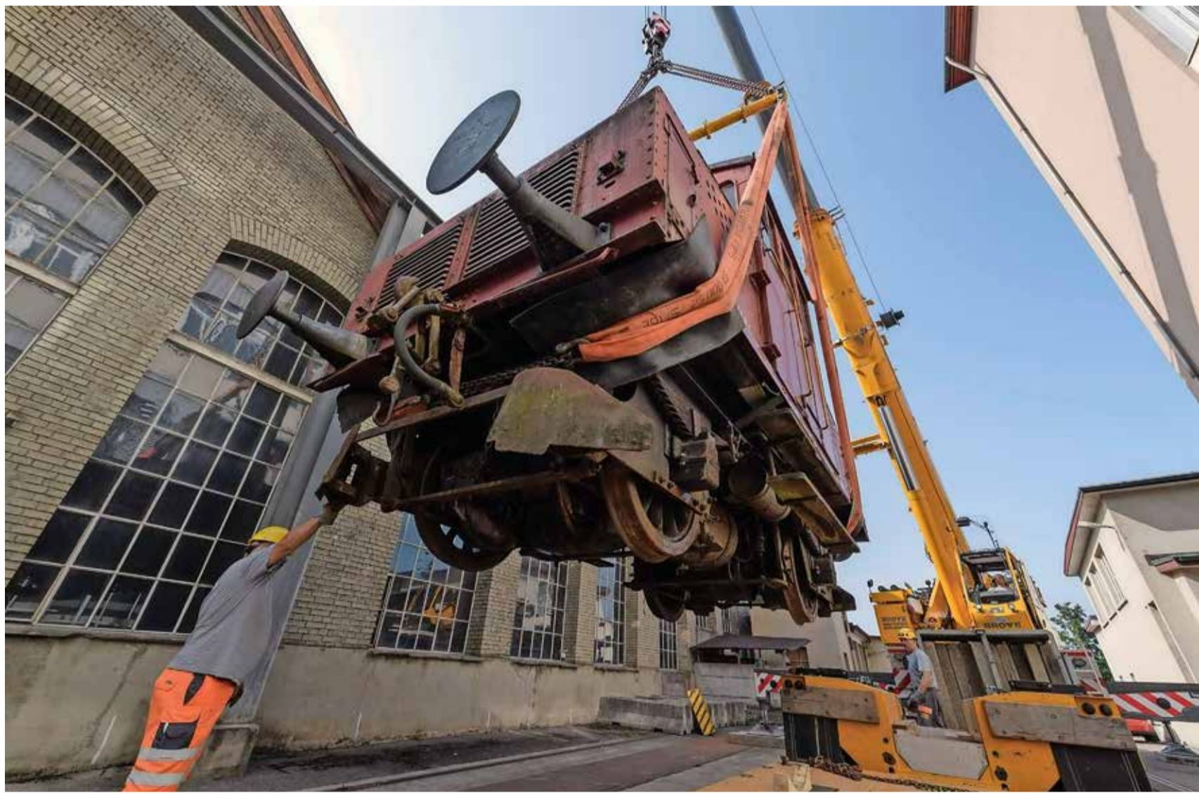
Die Werklok Ee 2/2 wird vom Tiefbettanhänger auf das Gleisstück gehievt, wo sie nun bis auf Weiteres zu Hause sein wird. Die Lok ist klein, nur 6,3 Meter lang über Puffer, aber doch 20 Tonnen schwer. Die Lok wurde von der SIG selber gebaut. Vor den Rädern sieht man die Bleche für die Schneerräumung.
